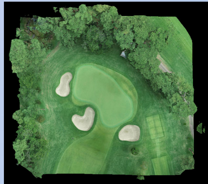
グリーン上を撮影し、数百枚の写真を統合し3Dモデルにしました。(3D)
